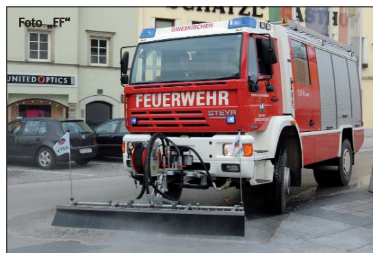
Der neue Straßenwaschbalken am Tanklöschfahrzeug bewährte sich hervorragend bei den Reinigungsarbeiten nach den schweren Unwettern Ende Mai.
