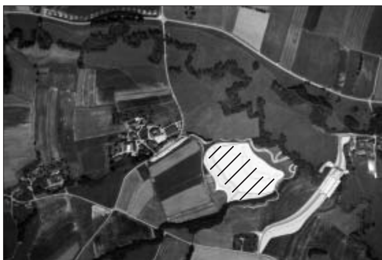
Rückhaltevolumen: 900.000 m 3 Bauzeit: Herbst 2007 bis Frühjahr 2009 Bauherr: Wasserverband Trattnachtal Planung: Zivilingenieurbüro Lohberger-Thürriedl-Mayr
